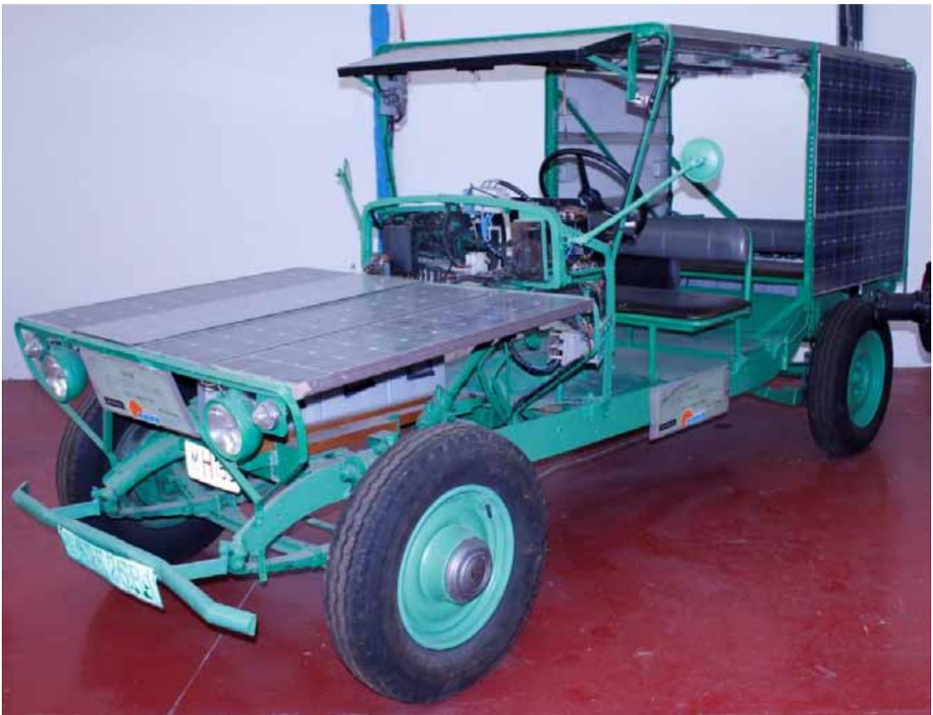
**VEHÍCULO ELECTROSOLAR FABRICADO A PARTIR DE UN CHASIS DE CITROËN PATO DE 1932**
