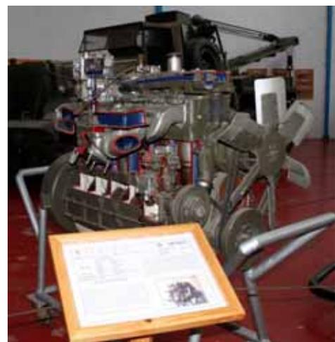
A continuación vemos el Motor seccionado Continental R6602, fabricado en Estados Unidos en 1941. Se trata de un motor de seis cilindros en línea, con una cilindrada total de 9.866 cc, que llegó a España en el año 1950 con los camiones Continental M-41 de 5 TM, como parte de la ayuda americana al Ejército español, un camión todo terreno que podía alcanzar los 81 km/h.
