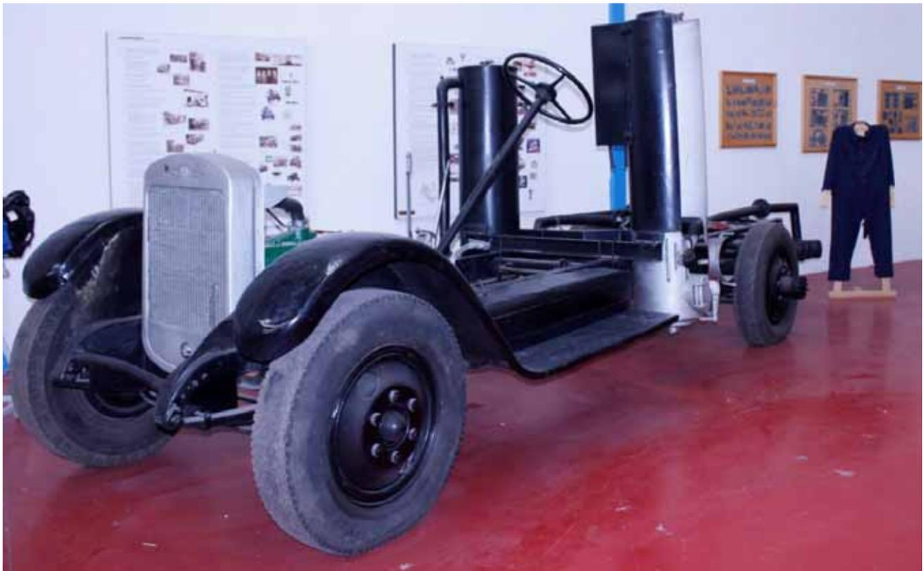
**CAMIÓN 3HC, DE FABRICACIÓN RUSA, PREPARADO PARA FUNCIONAR CON GASÓGENO.**
