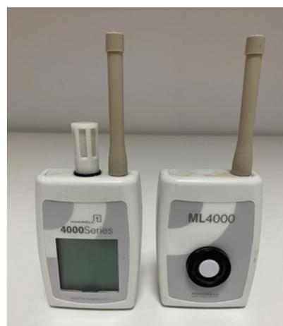
*Modelos de Data Logger y de luxómetro*
