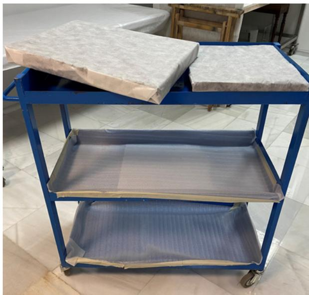
*Carro con ruedas de goma para transportar fondos con materiales barrera en las baldas*
