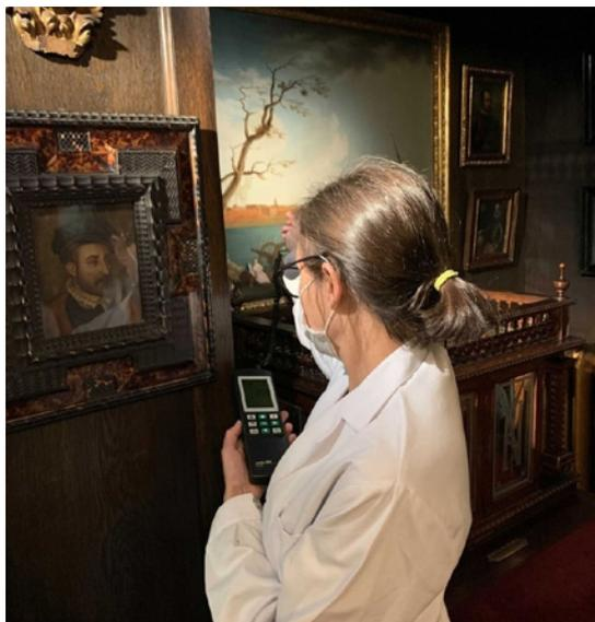
*Medición de la incidencia de la luz con un luxómetro.*
