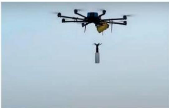
Octocóptero R18 fabricado por Aerorozvidka, transportando dos granadas antitanque RKG-3 y RKG-1600 de origen soviético. (Foto: [www.dronedj.com](http://www.dronedj.com))
