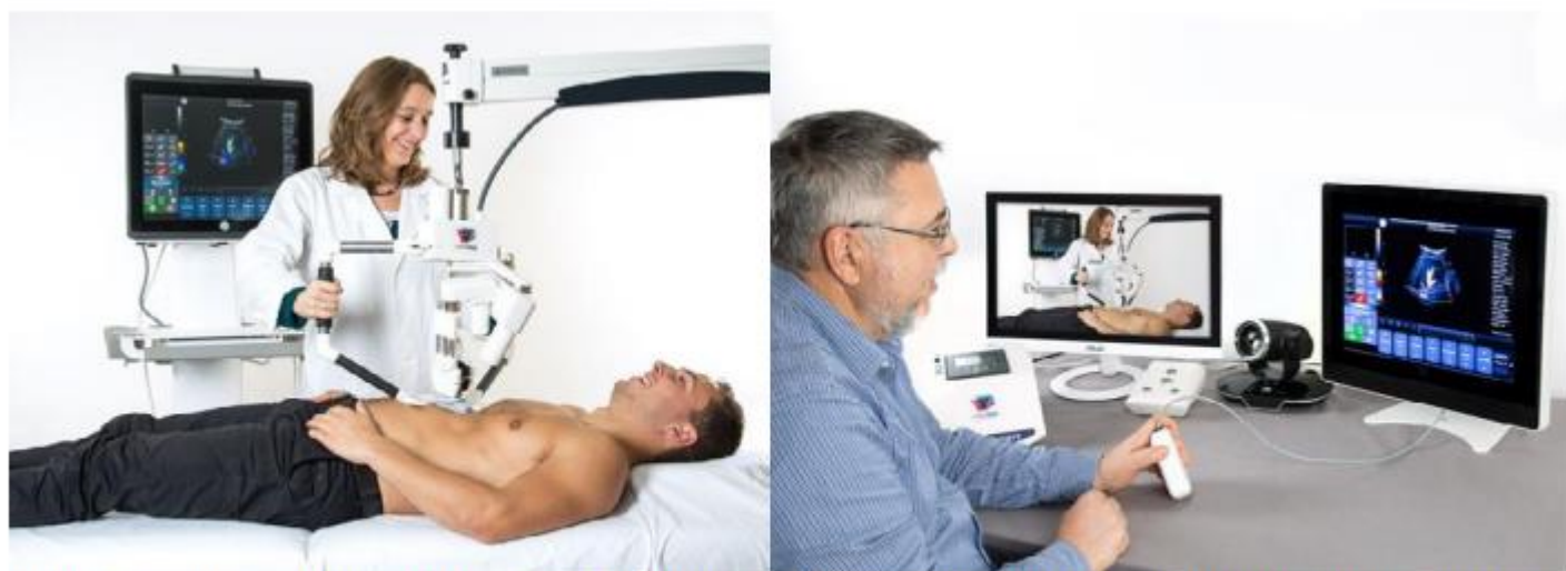
Figura 3. Sistema TESSA en su versión terrestre (Melody systems). Consta de tres componentes: la máquina de ultrasonido, el propio sistema Melody en forma de sonda de ultrasonido conectada a un brazo robótico, y un sistema de videoconferencia. Cortesía de AdEcho-Tech
